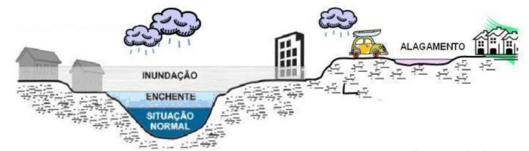
Figura 2 - Perfil esquemático que ilustra os distintos processos hidrológicos.
