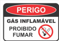
Figura 4 - Sinalização da central de GLP
