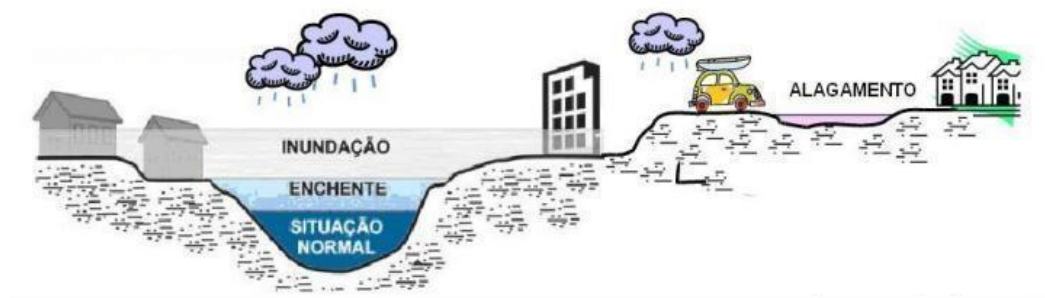
Figura 2 - Perfil esquemático que ilustra os distintos processos hidrológicos. Fonte: Min. Cidades/IPT, 2007.
